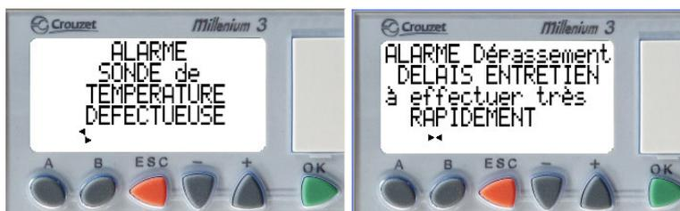
L'alarme sonde de température s'éteint lorsque la sonde est remplacée
