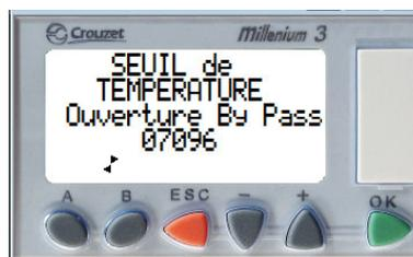
Réglage de la température d'ouverture du by-pass
