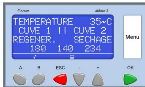
Après ouverture du coffret, on peut accéder au clavier du régulateur et réaliser ainsi les opérations de paramétrages décrites plus loin.
