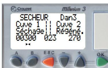
En fonctionnement normal, l'afficheur indique la situation des 2 cuves
