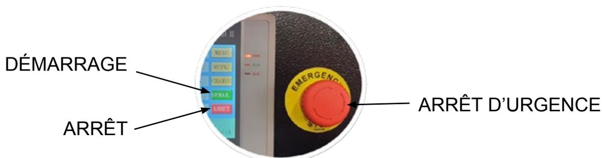
Les compresseurs sont réglés en sortie d'usine à 10 bar. Arrivés à cette pression la machine passera en mode marche à vide plusieurs minutes, ce temps doit être ajusté pour éviter de dépasser plus de 6 démarrages / heure au moteur .
